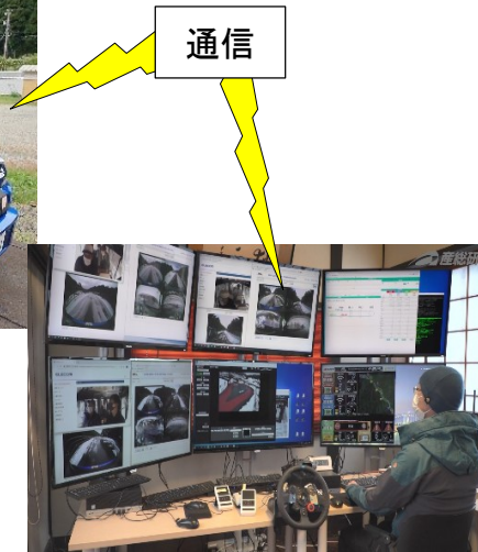
遠隔監視・操作室
