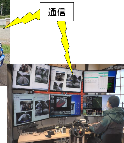
遠隔監視・操作室
