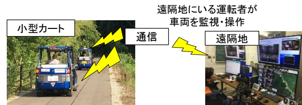
遠隔監視・操作型のラストマイル自動運転の実証実験 (主体:産総研等、場所:福井県永平寺町等)
