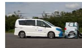
衝突被害軽減ブレーキの性能認定試験(イメージ)
