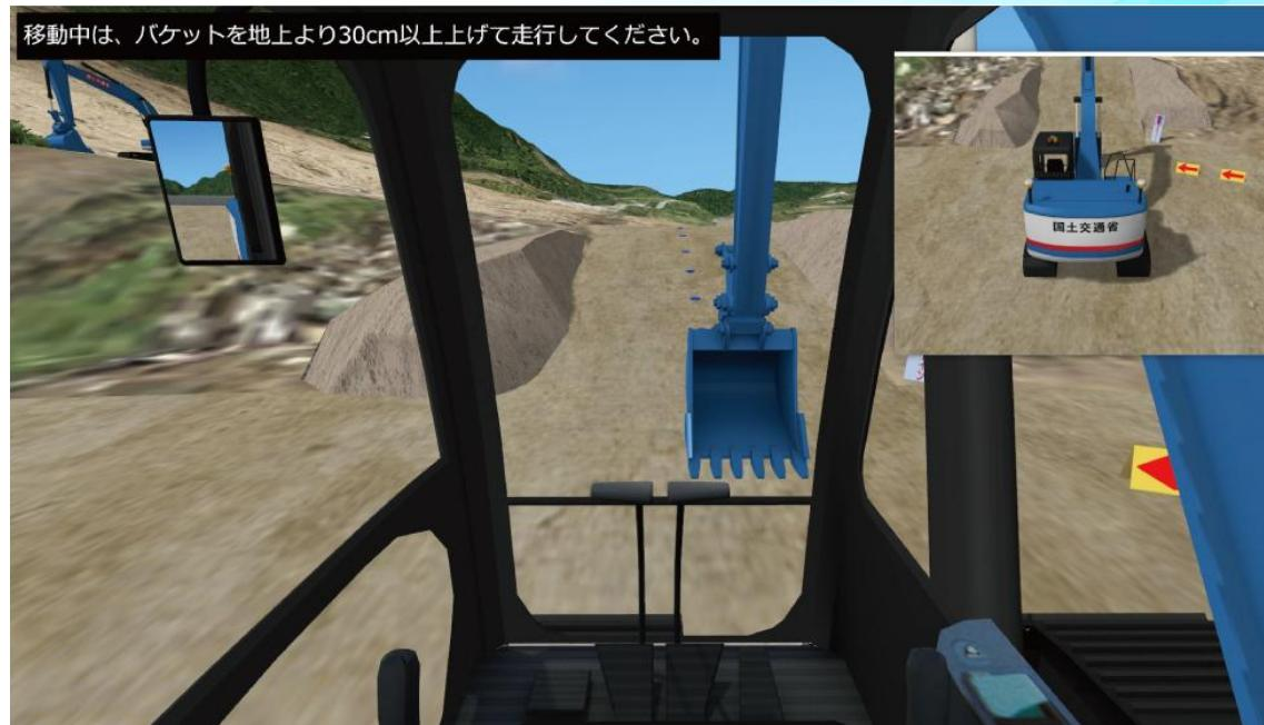
2016年に発生した熊本地震により崩落してしまった阿蘇大橋周辺を再現しています。写真データは実際の被災現場を空撮したものを使用しており、当時の被害状況がわかるようになっています。このVRデータを用いて、実際の遠隔操作用のコントローラを接続して災害時における初期初動対応を目的とした分解組立型バックホウの遠隔操作訓練シミュレータを構築しています。
