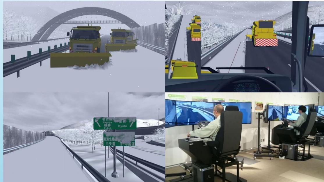
除雪車両オペレータ育成を目的とした訓練シミュレータを開発した。実車両に近い感覚での訓練を行うため、高速道路の道路環境を再現し、走行位置の正確性や車間距離など必要な診断を行うことができる。複数台で行う梯団除雪訓練として3台のシミュレータが連携するが、他車両を自動制御とすることで最低1人での訓練も可能。
