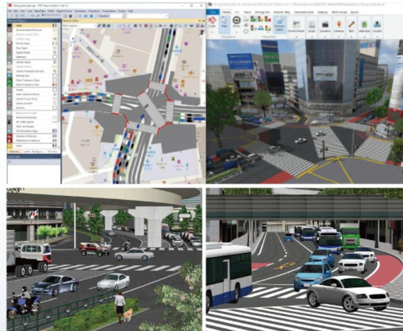
交通量・車輦プロファイルによるシミュレーションに対応。自動車性能や縦断勾配を考慮した検証、ターミナル建設に伴う交通流シミュレーションが可能です。
