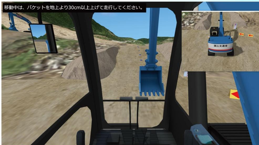
2016年に発生した熊本地震により崩落してしまった阿蘇大橋周辺を再現しています。写真データは実際の被災現場を空撮したものを使用しており、当時の被害状況がわかるようになっています。このVRデータを用いて、実際の遠隔操作のコントローラを接続して災害時における初期初動対応を目的とした分解組立型バックホウの遠隔操作訓練シミュレータを構築しています。
