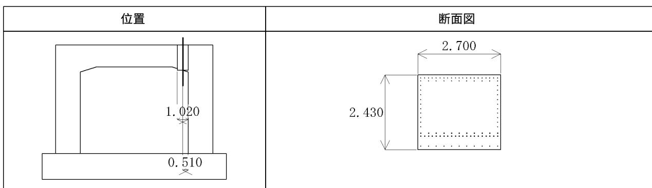
コンクリートの設計基準強度  $c_k = 21 \text{ (N/mm}^2\text{)}$ コンクリートのヤング係数  $E_c = 23500 \text{ (N/mm}^2\text{)}$
