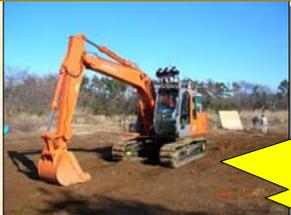
オペレータの無線操作に対し、建設機械に搭載したGPS、地形レーザスキャン等の情報を無線LANにて受信し、UC-win/Roadの3D可動モデルにその動きを定義して、遠隔状態でのリアルタイムで作業状況を確認できるマンマシンインターフェースの開発
